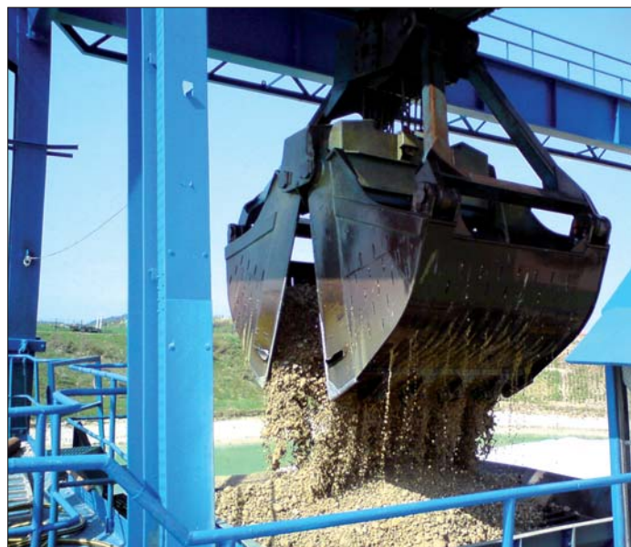
Le tout-venant est extrait à la drague flottante sur le site de Lafarge Gerstheim, situé près de Strasbourg
